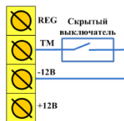
Рисунок 6.5 — Схема подключения скрытого выключателя или кнопки
