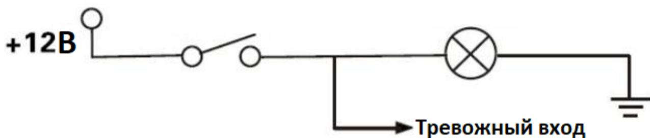
Схема подключения тревожного выхода:
