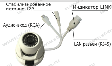
Рис. 1 Схема подключения видеокамеры
