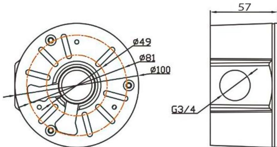
Не подходит для PTZ камер и с диаметром оси монтажных отверстий основания камеры больше 81 мм, например:
