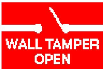
Появится, когда закручен винт настенного тампера. Это сообщение также появится в конце последовательности включения питания, если винт вскрытия был открыт во время включения. Датчик войдет в режим меню после завершения последовательности включения питания.
