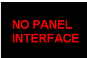
Появляется в рабочем режиме, если любой из проводов шины Digiplex отключен или неисправен. Это сообщение появляется только один раз в конце последовательности включения питания. Как только шина Digiplex подключена правильно, это сообщение исчезнет и появится, только если шина еще раз отключена или неисправна.
