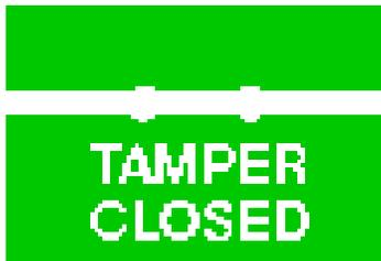
Появляется, когда винт тампера на нижней части устройства плотно закрыт. Это означает, что устройство перешло в рабочий режим.
