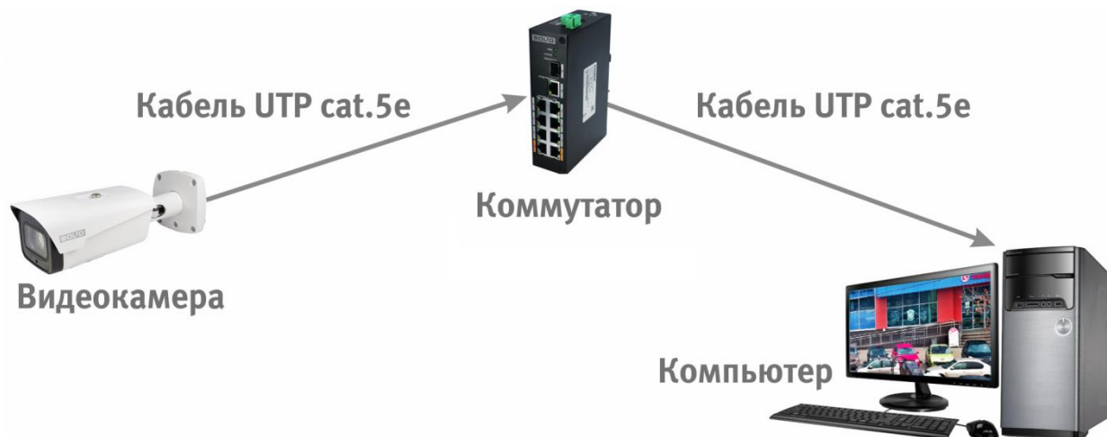
Рисунок 6.4 – Схема подключения видеокамеры к компьютеру через коммутатор
