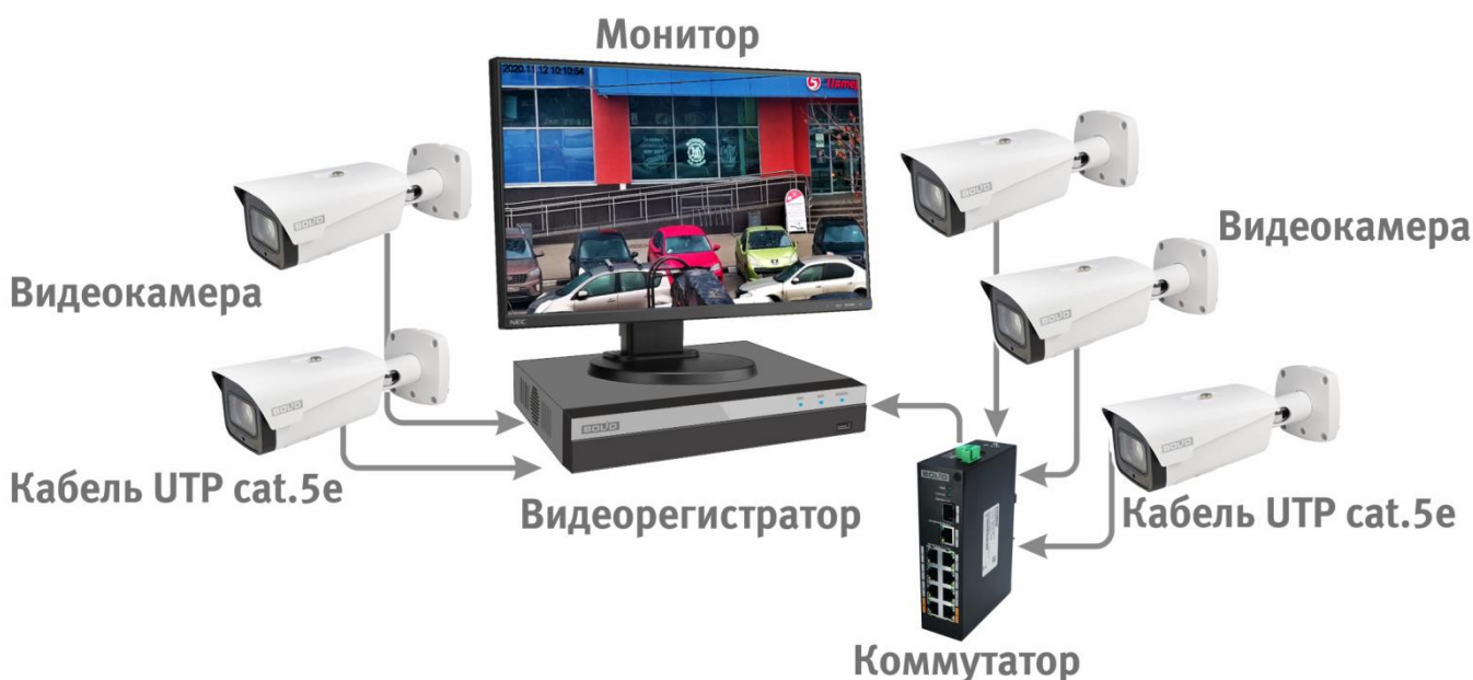
Рисунок 6.5 – Схема подключения видеокамеры к видеорегистратору
