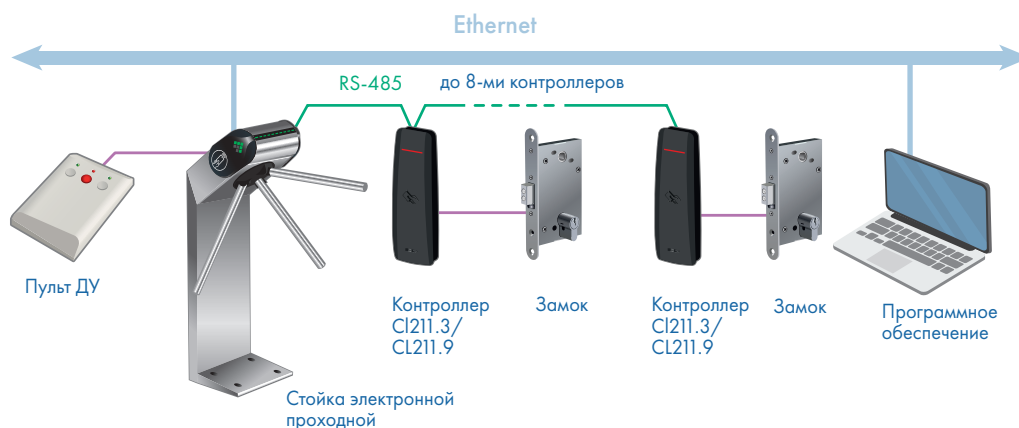
Структурная схема подключения электронной проходной
