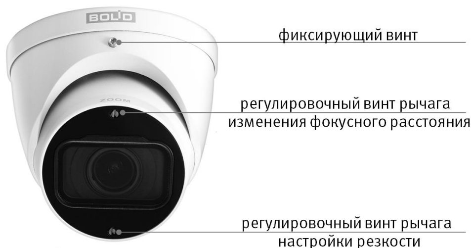
Рисунок 6.4 – Настройка фокусного расстояния и направления объектива
