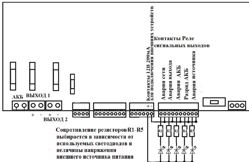
Рисунок 9 – Подключение внешних индикаторов.
