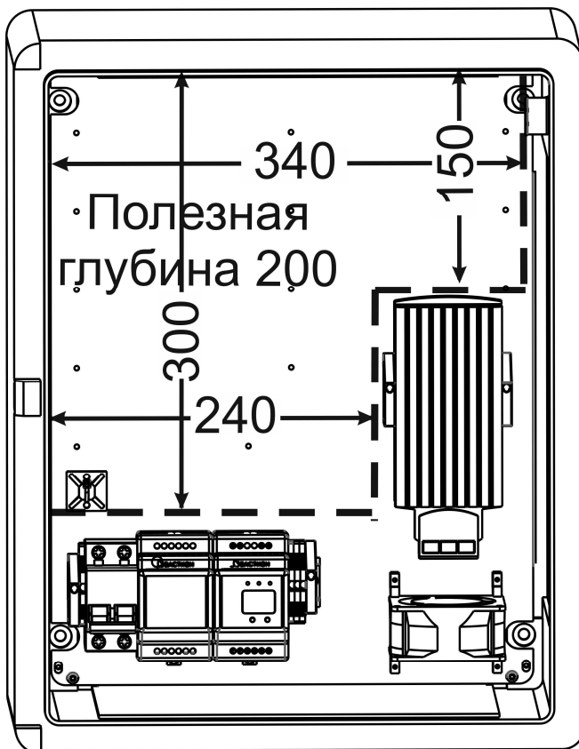
Рисунок 1 – Пространство внутри для установки доп. оборудования
